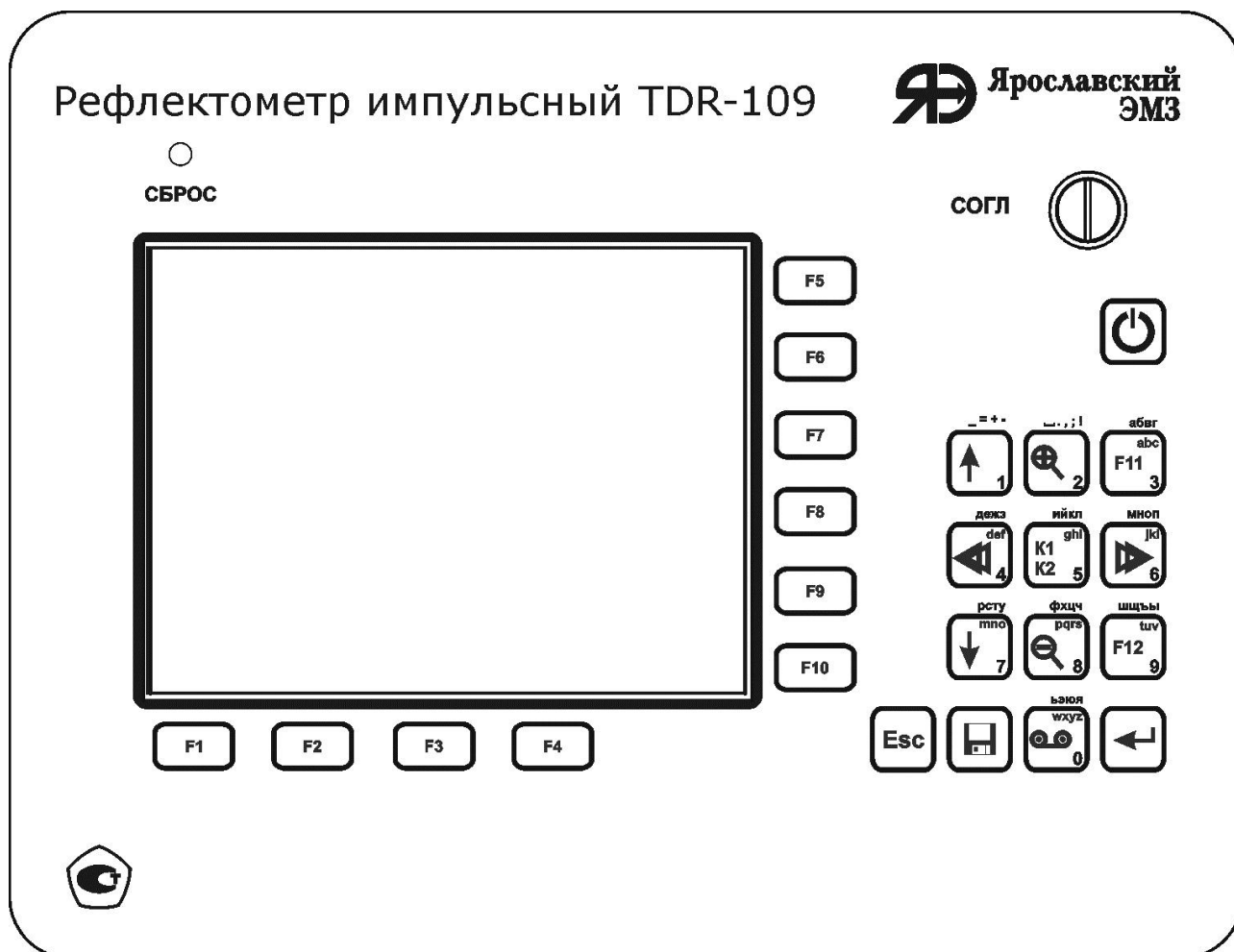
Рисунок 4-4. Лицевая панель прибора TDR-109
